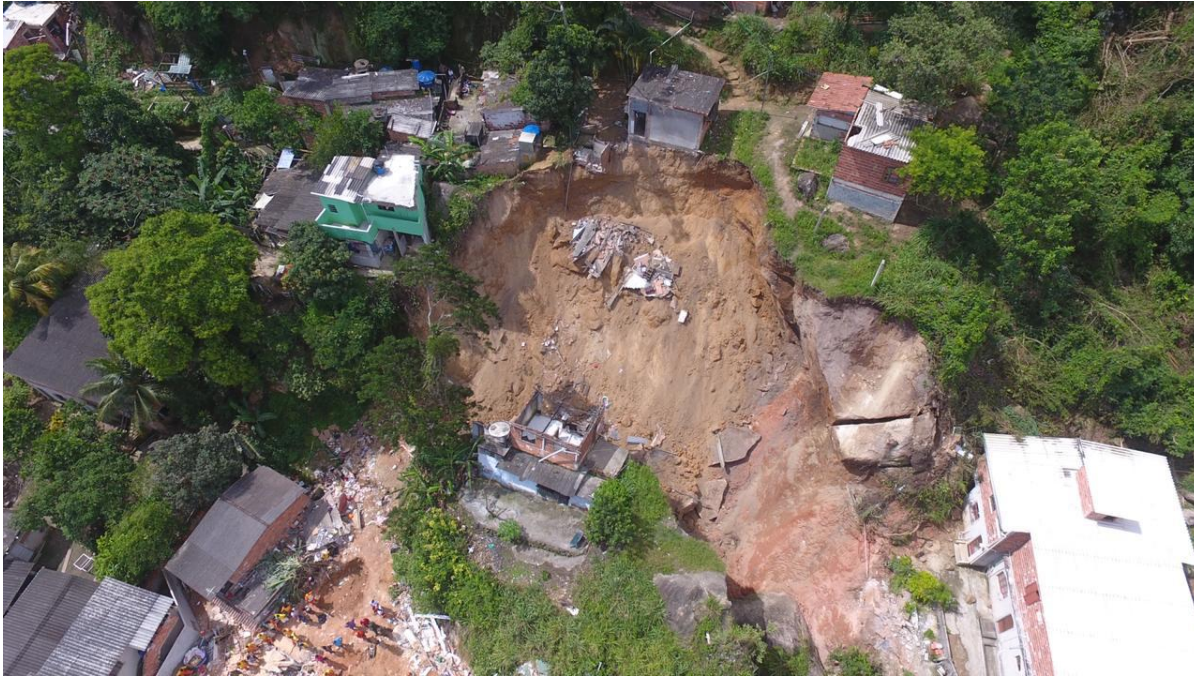
Figura 1 - Cicatriz e talude gerado a partir de deslizamento na comunidade Boa Esperança. Novembro, 2018. Fonte: os autores.
