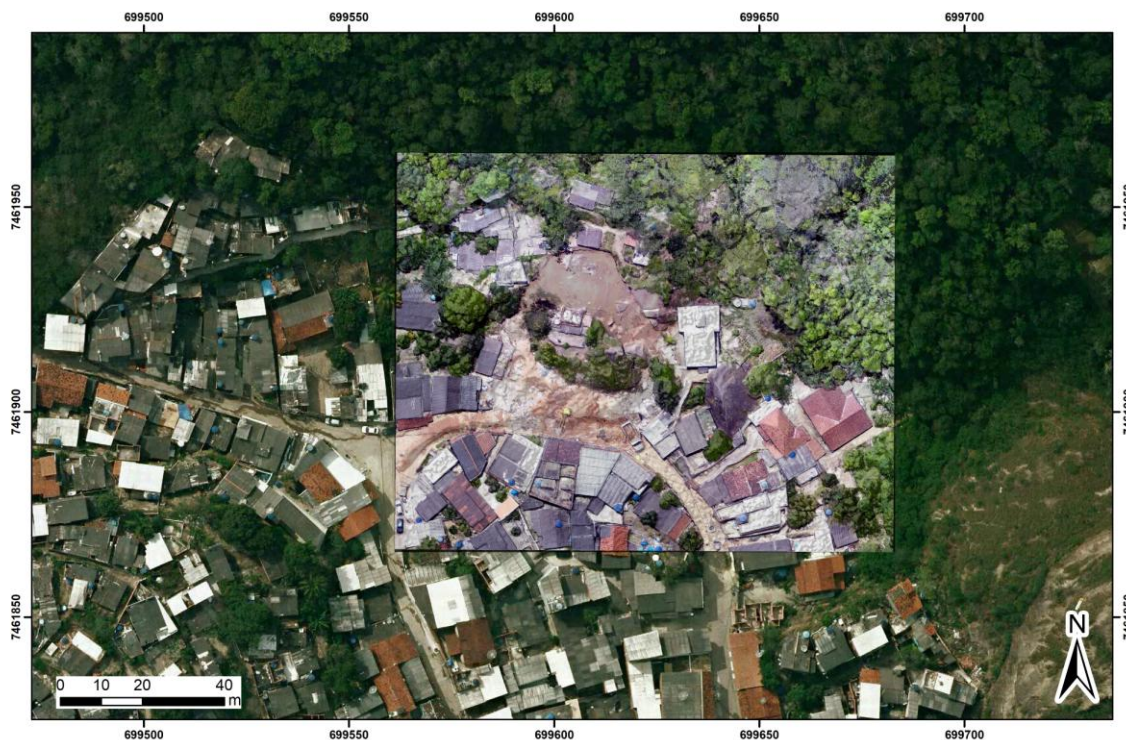
Figura 3 - Ortomosaico gerado a partir de imagens provenientes de RPA (ao centro. Ao fundo, ortofotos do levantamento aerofotogramétrico de 2014).
